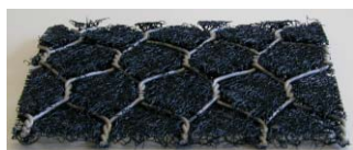
Esempio di struttura di geostuoia rinforzata con rete a doppia torsione
